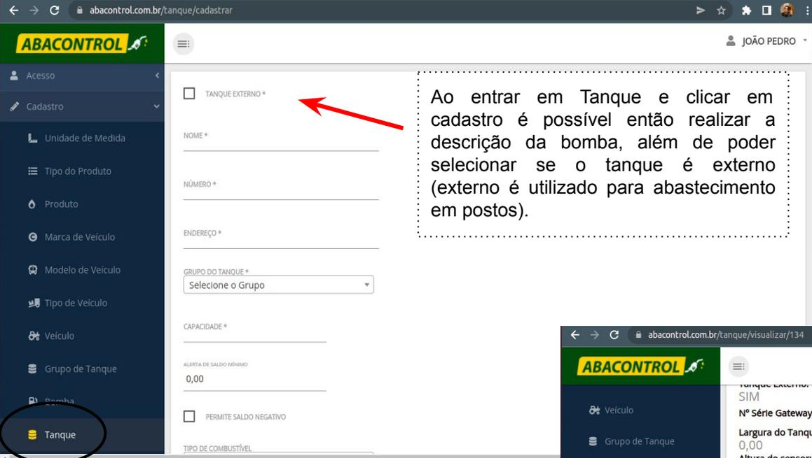
Ao entrar em Tanque e clicar em cadastro é possível então realizar a descrição da bomba, além de poder seleccionar se o tanque é externo (externo é utilizado para abastecimento em postos).
